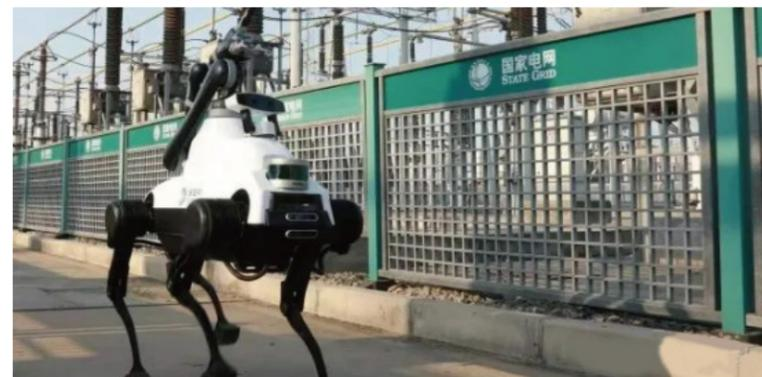
基于绝影设计的集控站巡视一体化机器人，截至2022年1月底，该机器人已代替人工进行了87次站次巡检，节省人工巡检时长380工时，参与远程应急处理5次，节约人工处理时长35工时。
