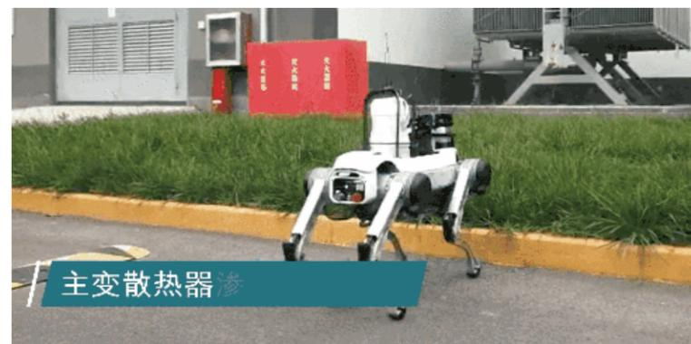
采用绝影进行二次开发，目前搭载机械臂的该四足机器人巡检已经落地国网河北电力，基于绝影X20研发的新一代也即将亮相。
