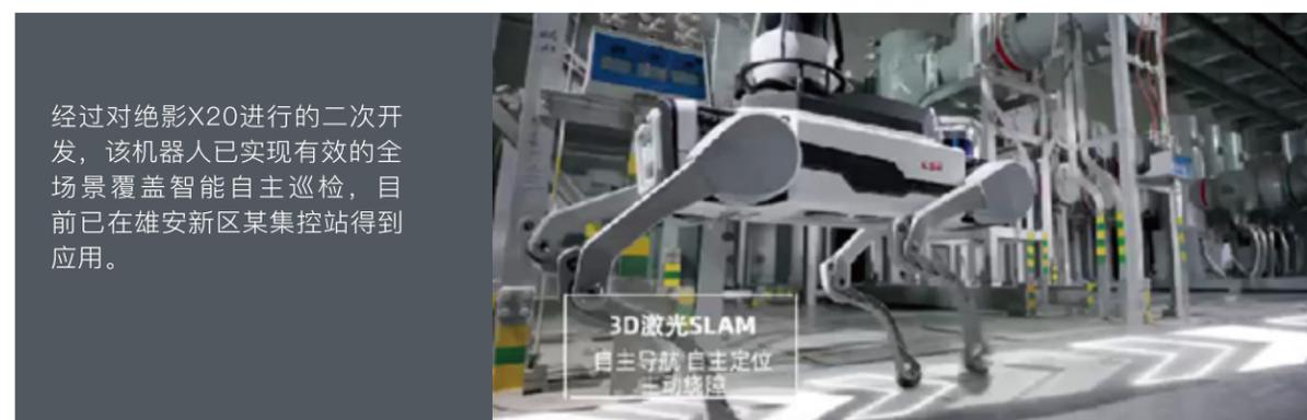
经过对绝影X20进行的二次开发，该机器人已实现有效的全场景覆盖智能自主巡检，目前已在雄安新区某集控站得到应用。
